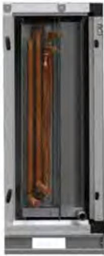
Подвод холодоносителя для водяных воздухоохладителей необходимо осуществлять по противоточной схеме. Фреоновые охладители могут оснащаться капиллярными термостатами на каждый контур для предотвращения обмерзания испарителя.
